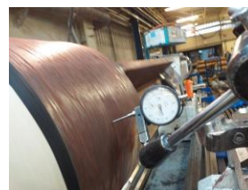
Sprawdzanie bicia na elemencie stalowym po jego prawidłowym montażu na obrabiarce
